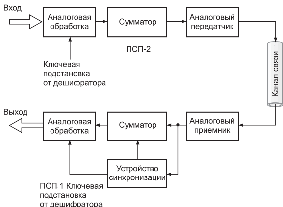
Рис. 3.36. Структурная схема маскиратора речевого сигнала заградительной помехой
