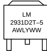
D2PAK D2T SUFFIX CASE 936
