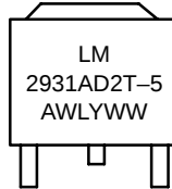
D2PAK D2T SUFFIX CASE 936
