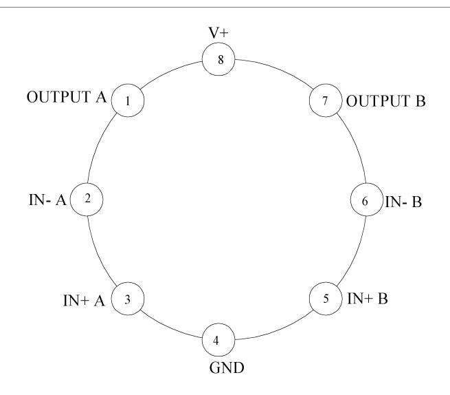
LM158AH, LM158H 8 - PIN METAL CAN CONNECTION DIAGRAM TOP VIEW P000273A
