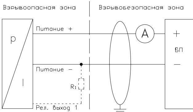
БП – искробезопасный блок питания
