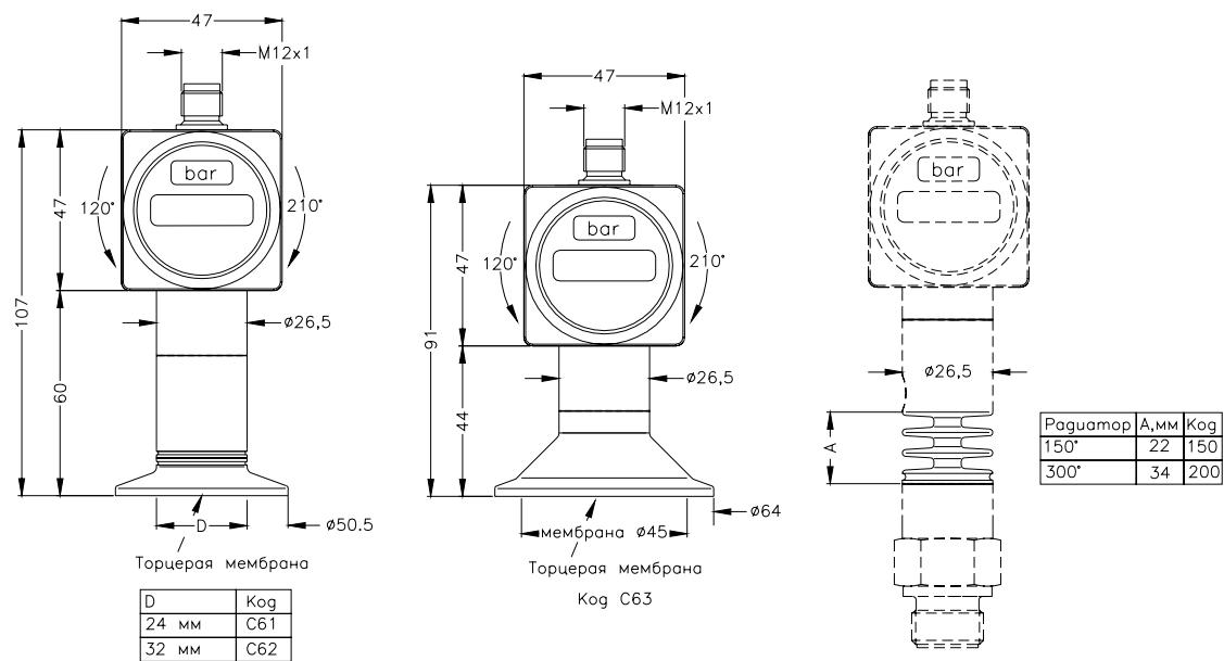
Механические присоединения в соответствии с DIN 11851 (“Молочная гайка”)
