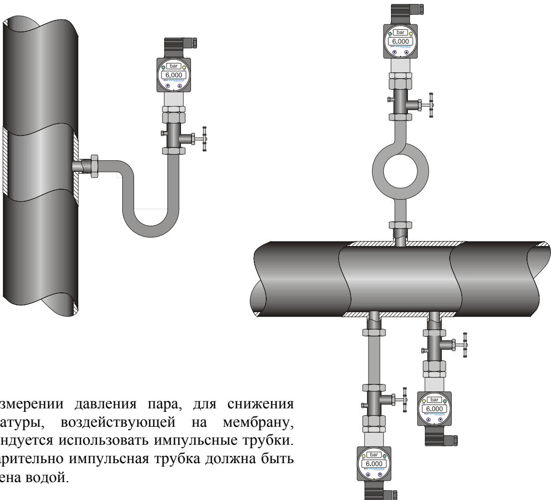
**Рисунок 3.** Монтаж датчика для измерения давления пара.
