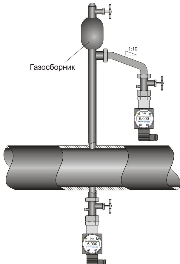
**Рисунок 2.** Монтаж датчика
