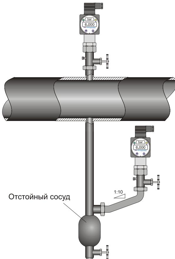
**Рисунок 1.** Монтаж датчика
