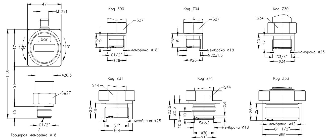
Длина датчика DS 200P в испаробезопасном исполнении больше на 20 мм.
