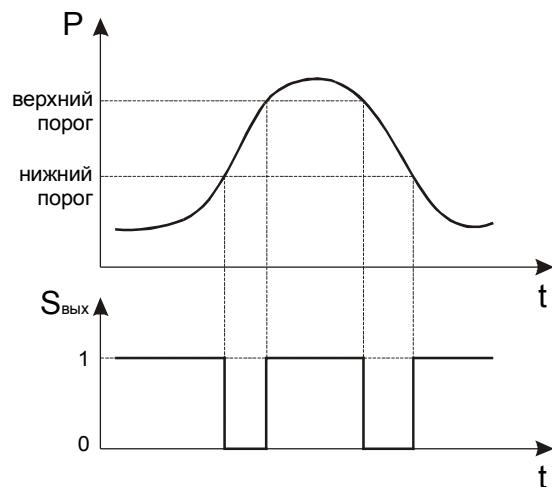
Рисунок 1. Режимы работы релейных выходов
