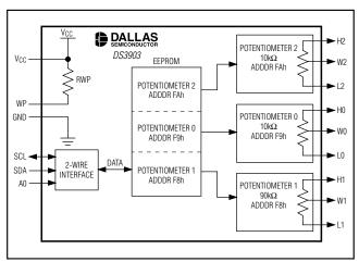
Figure 1. DS3903 Block Diagram
