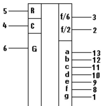
Микросхема представляет собой счётчик - делитель на 2 или на 6 с выходом на семисегментные индикаторы. На вход С подаётся тактовая частота, на R асинхронный сигнал сброса с активным высоким уровнем. На вход G подаются модулирующую импульсную последовательность с частотой 32 или 64 кГц., необходимый для работы электролюминисцентных или жидкокристаллических индикаторов.
