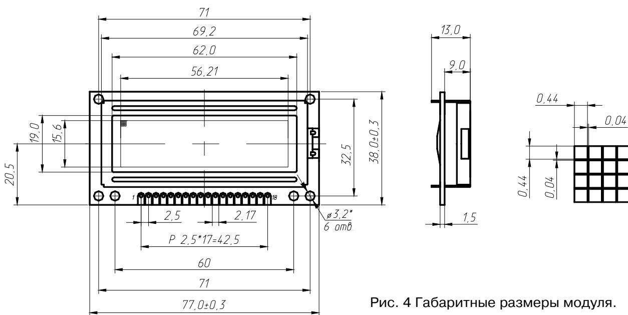
Рис. 4 Габаритные размеры модуля.
