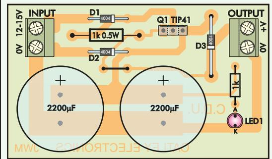
**CAPACITOR DISCHARGE POINT MOTOR DRIVER**
