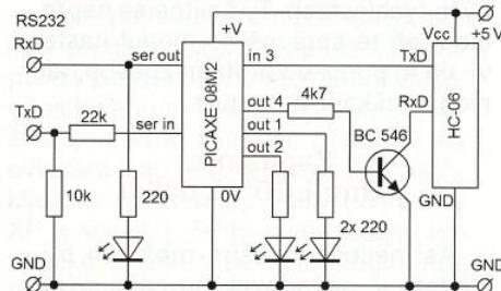
Obr. 10. Ovládání tří LED - PICAXE
