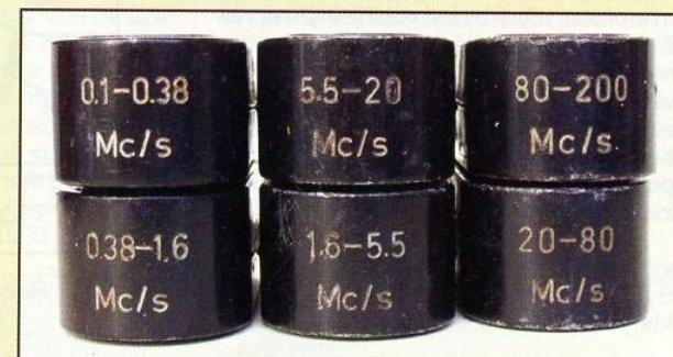
Obr. 5. Sada výměnných cívek
