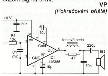
Obr. 120. Doporučené zapojení obvodu
