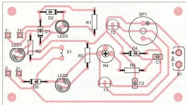
Obr. 3. Osazovací plánek
