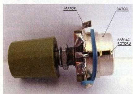
Obr. 4. Ladící kondenzátor
