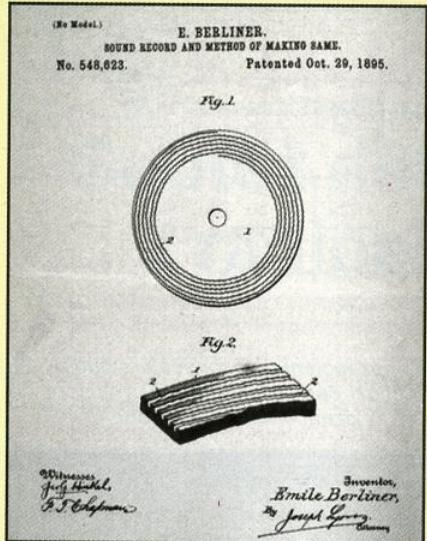
Obr. 4. Patentová přihláška na spirálovitý záznam zvuku
