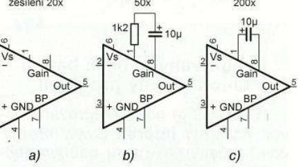
Obr. 121. U obvodu LM386 lze napěťové
