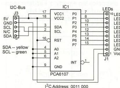
Obr. 49. Pripojenie obvodu PCA6107
