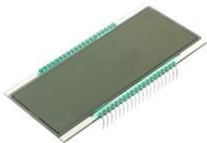
**Сегментные индикаторы** предназначены для отображения информации состоящей из сегментов (7-сегментные - для отображения цифр, 14/16-сегментные - для отображения текста, шкальные - для отображения шкалы). Данные дисплеи нашли широкое распространение в различной измерительной аппаратуре, кассовых аппаратах, калькуляторах, часах, простых счетчиках электроэнергии, на заправочных станциях.
