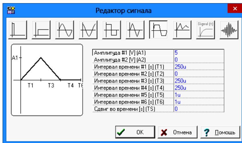
Рис. 10. Настройки для получения нужного вида сигнала
