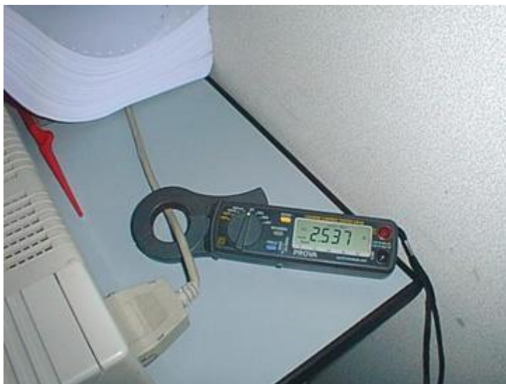
Рис.4. Ток по интерфейсному принтерному кабелю параллельного (LPT) порта
