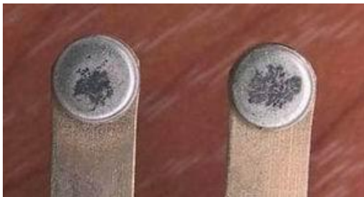
Рис. 2 - Вид контактов электромагнитного реле, проработавшего некоторое время
