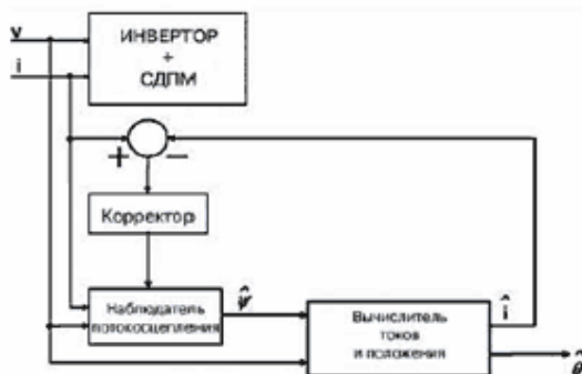
Рис. 12. Структурная схема вычислителя положения ротора ВД
