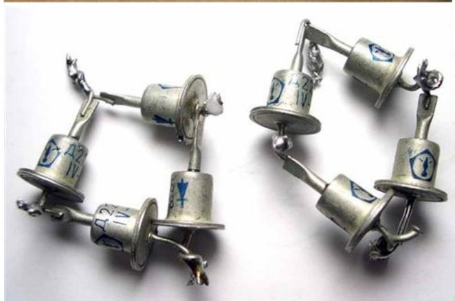
Диодный мост имеет вход и выход. Выводы, которые обозначены AC или ~, используют для подключения переменного напряжения, а выводы + и -, это и будут полярные выходы, к которым и будем подключать конденсатор. Конденсаторы тоже полярные и имеют положительный и отрицательный выводы их нужно подключить к соответствующим выводам диодного моста, как показано на схеме.
