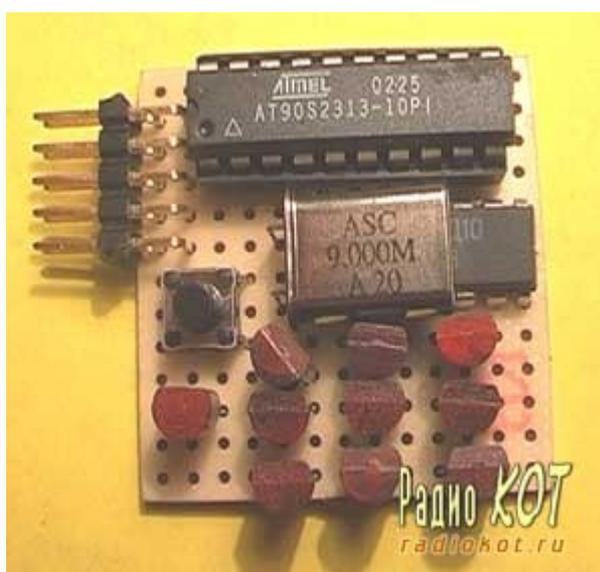
Моем, проводим жилками соединения, а также впаиваем SMD -резисторы и конденсаторы. Резисторы показаны рыженьким, конденсаторы – синеньким. Лучше всего брать SMD -компоненты
