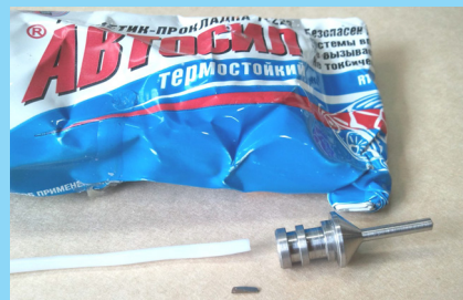
Рис. 10. Вверху – тубик с герметиком, ниже слева – фторопластовая защитная трубка диаметром 2 мм, которая одевается на выходящие провода, справа – корпус ТД (внутренний диаметр канала – 1,5 мм, внешний 2,5 мм), внизу фиксирующий металлический (стальной) клин из проволоки диаметром 1,5 мм, длина – 5 мм
