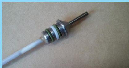
Рис. 2. Фото готового ТД (с уплотнительными резиновыми и фторопластовыми кольцами под посадочную нишу в месте крепления)
