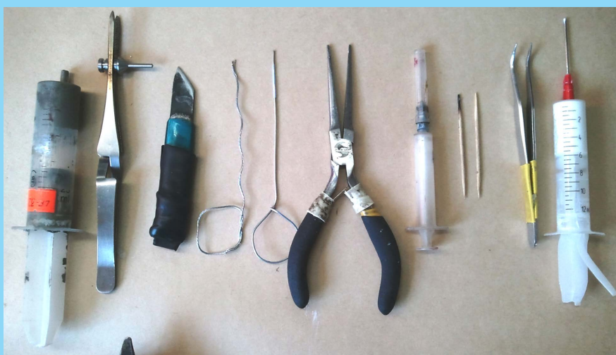
Рис. 12. Слева-направо: шприц с паяльной пастой LF320, медицинский зажим с корпусом ТД, нож для зачистки проводов, тросик для прочистки канала корпуса ТД, проволока для "распяливания" фторопластовой трубки перед вставкой в неё узла проводов с диодом, длинногубцы с плоскими рабочими поверхностями для "расплющивания" проводов, шприц со спиртом для промывания канала корпуса ТД, две зубочистки: левая для работы с паяльной пастой, правая – с герметиком, пинцет с загнутыми концами, шприц с теплопроводной пастой КПТ-8
