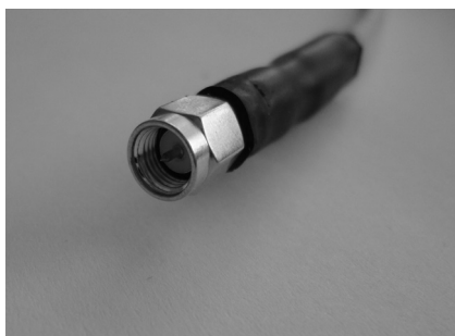
Рис. 7. Гермоизоляция коннектора и фидера термоусадкой
