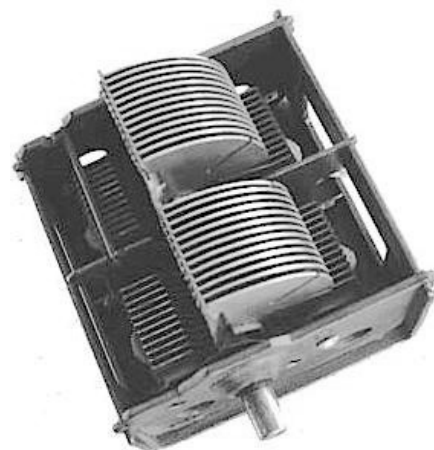
Рис. 2. Фото стандартного широко распространённого двухсекционного КПЕ (применялся в радиоприёмниках второго - четвёртого классов)
