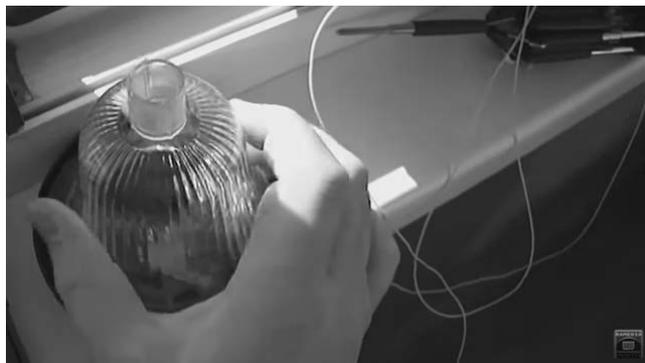
Рис. 7. Работа вечного Wi-Fi логгера в корпусе садового фонаря
