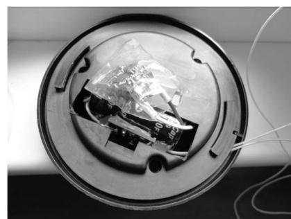
**Рис. 3.** Модуль ESP12. Монтаж подтягивающих резисторов и датчика DS18B20
