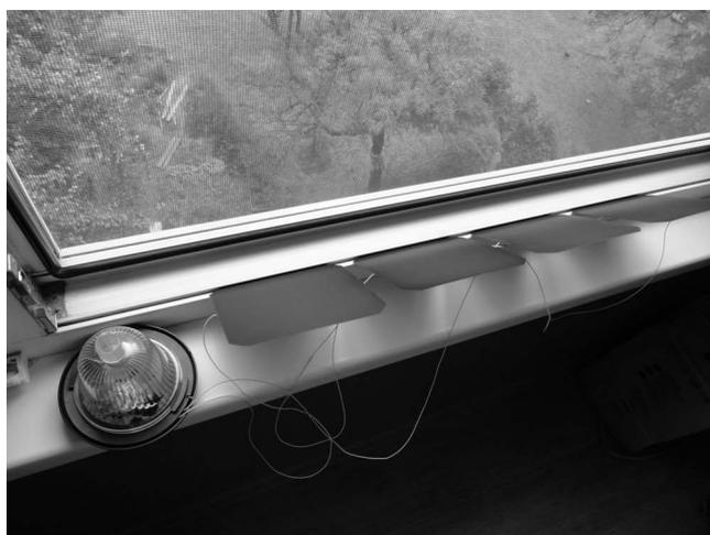
Рис. 1. Тестирование питания от солнечной панели из пластин аморфного кремния
