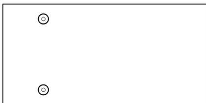
**Рис. 2.** Эскиз рычага телеграфного ключа (показаны отверстия для скрепления конструкции и их зенковка). Материал – фольгированный стеклотекстолит. Размеры: 100x50x1,5 мм
