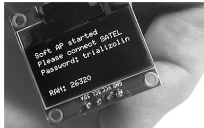
**Рис. 8.** Дисплей SSD1306. Отображение приглашения к подключению
