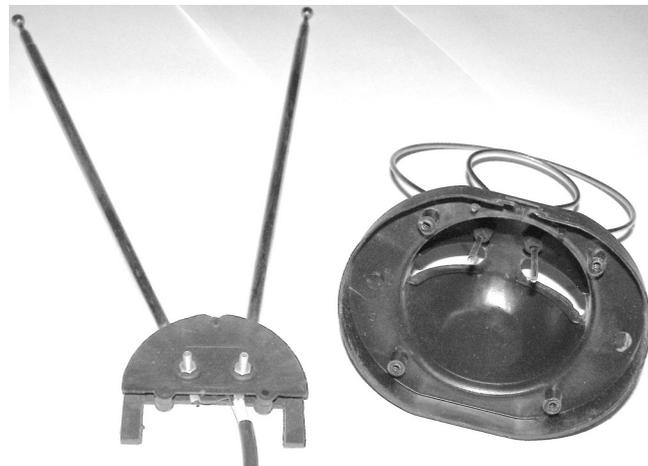
Рис. 3. Вид антенны в разобранном виде
