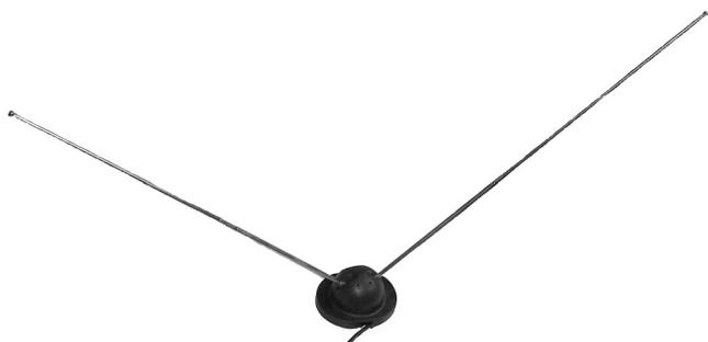
**Рис. 4.** Готовая УКВ радиоловительская антенна на основе телевизионной
