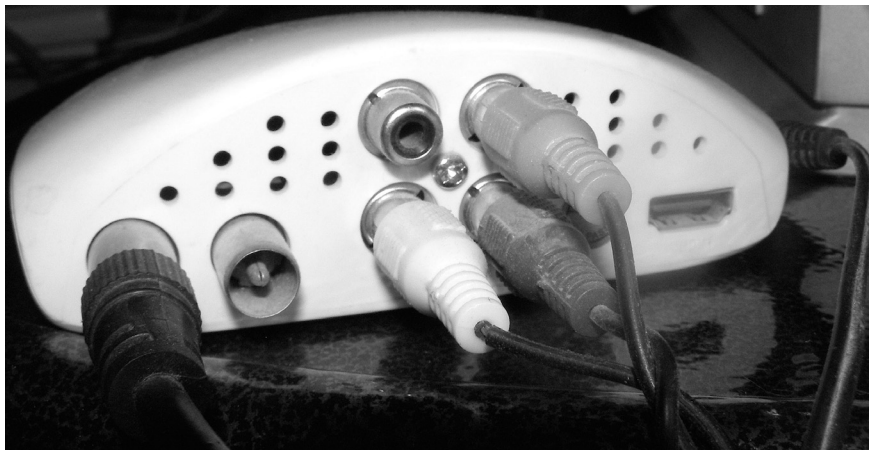
Рис. 3. ТВ приставка системы DVB-T2, подключенная к аналоговому телевизору и антенне.
