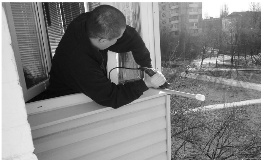
**Рис. 2.** Демонтаж выносного датчика DHT и замена на BME280
