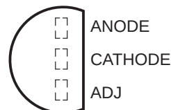
LM336-2.5, LM336B-2.5 . . . LP PACKAGE (TOP VIEW)
