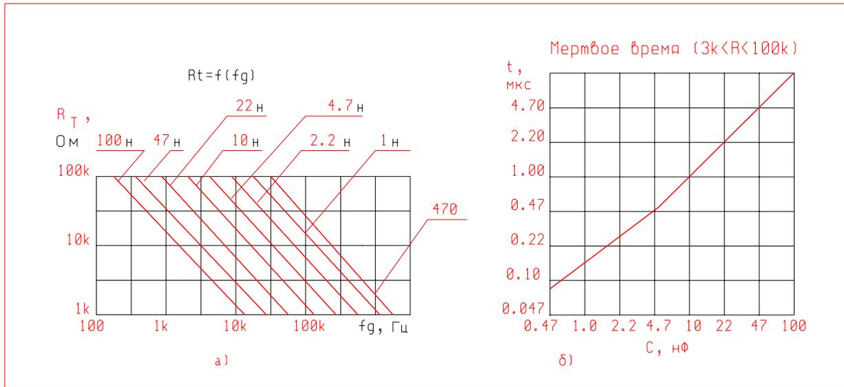
**Рис. 4. Частота (а) и мертвое время (б) генератора.**
