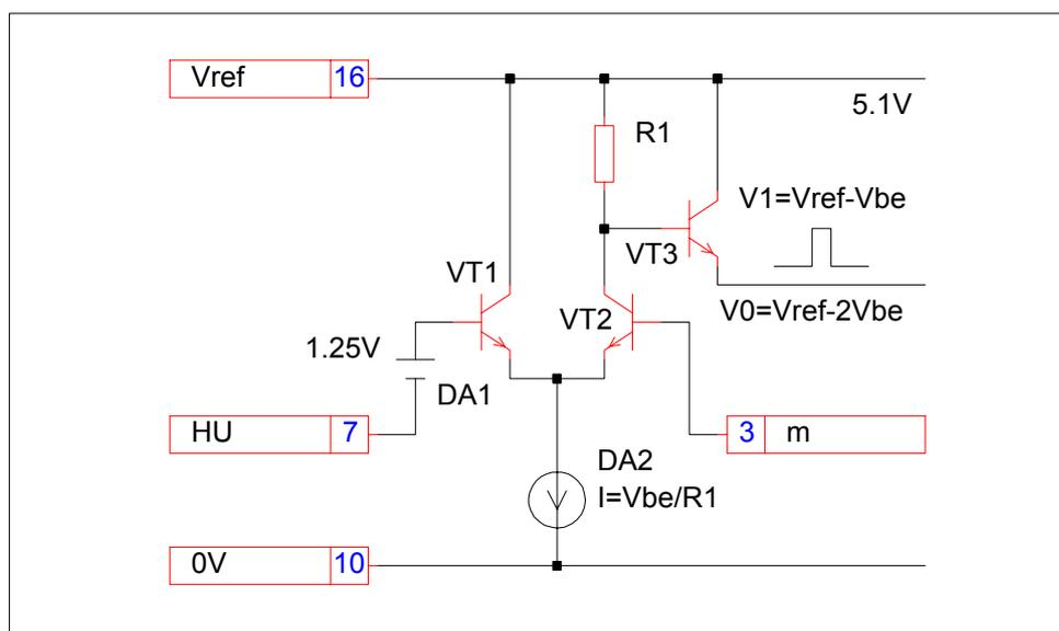
Рис. 8 ШИМ-компаратор.
