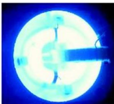
Рис. 3. Индукционный источник света с ртутно-аргоновым наполнением, мощностью 200-400 Вт.
