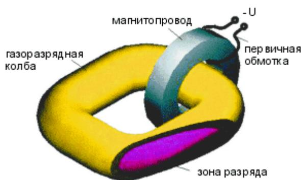
**Рис. 1. Принцип генерации индукционного разряда трансформаторного типа.**
