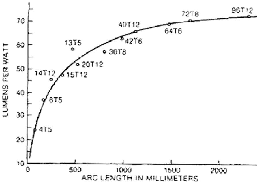
Световая отдача зависит от длины лампы. Как видно из графика, имеет смысл применять, например, одну лампу 40 Вт вместо двух ламп по 20 Вт.
