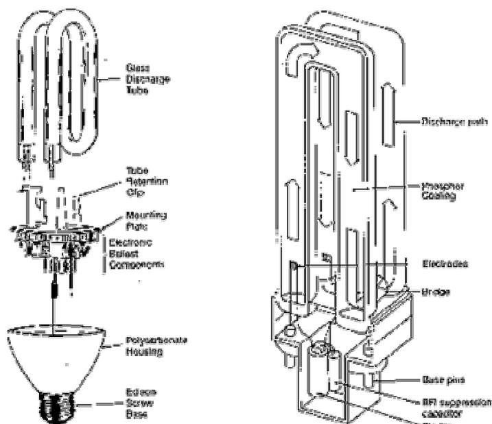
На рисунке показана конструкция компактных ламп. Слева - лампа, имеющая встроенный электронный
