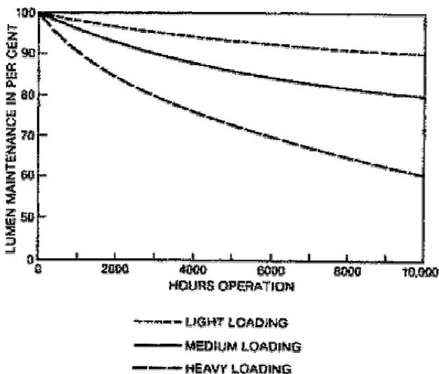
Светоотдача падает, причем заметно, на рисунке приведены средние данные для ламп в зависимости от электрической нагрузки:
