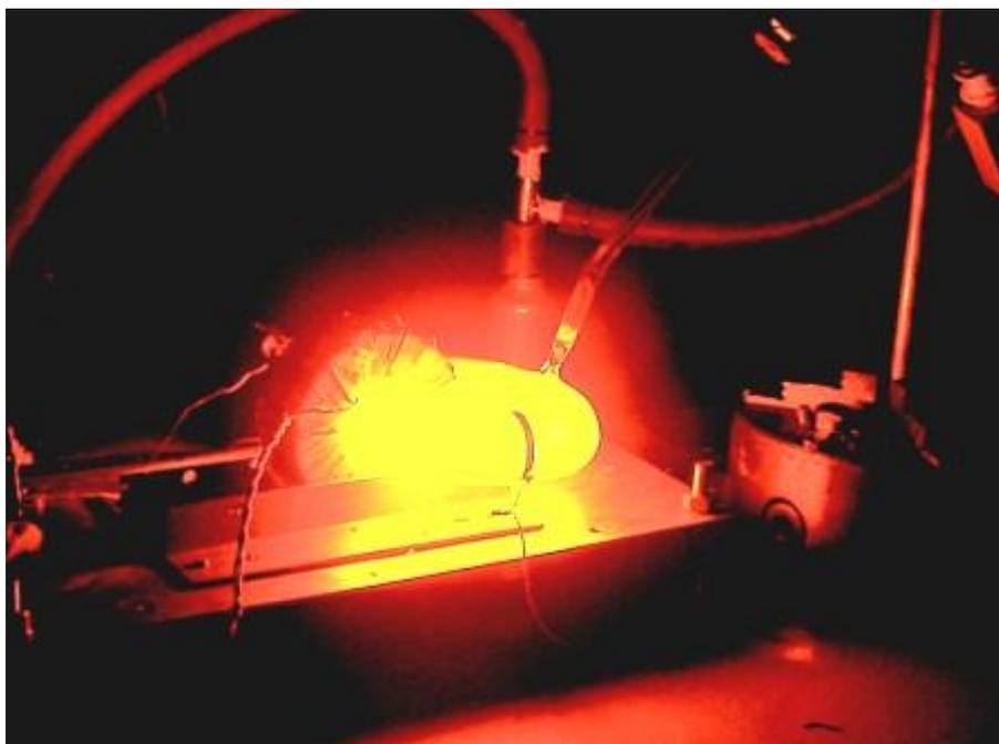
Рис. 4. Индукционный источник света с неоновым наполнением, Мощностью до 500 Вт.
