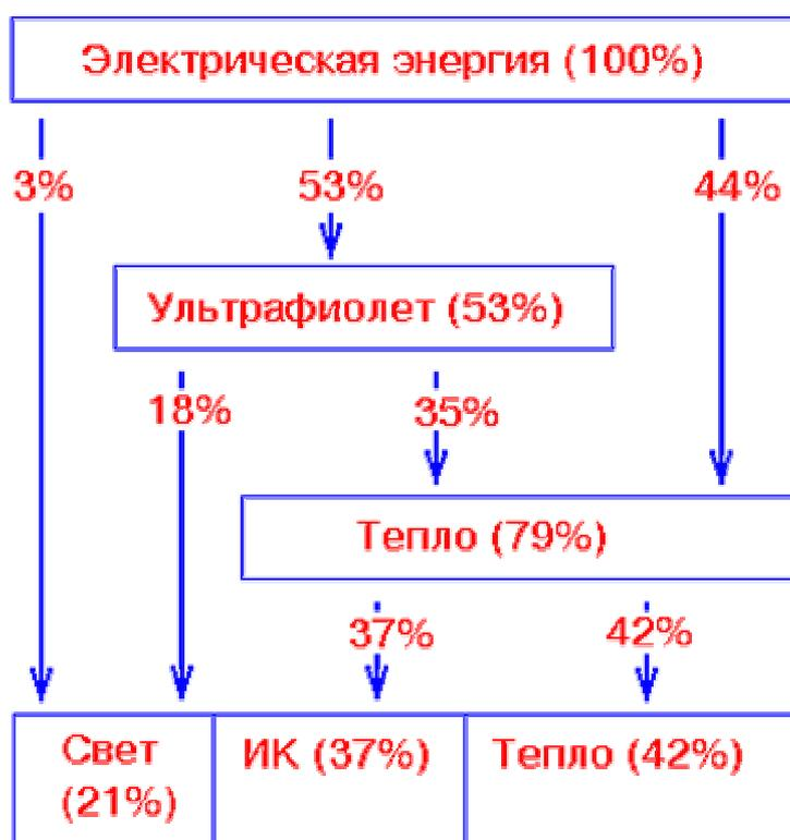
Несмотря на более высокую эффективность люминесцентных ламп по сравнению с лампами накаливания, все равно только небольшая часть подводимой энергии преобразуется в видимое излучение (не считая потерь в балласте). Большая часть энергии превращается в инфракрасное излучение (37%) и рассеяное тепло (42%).
