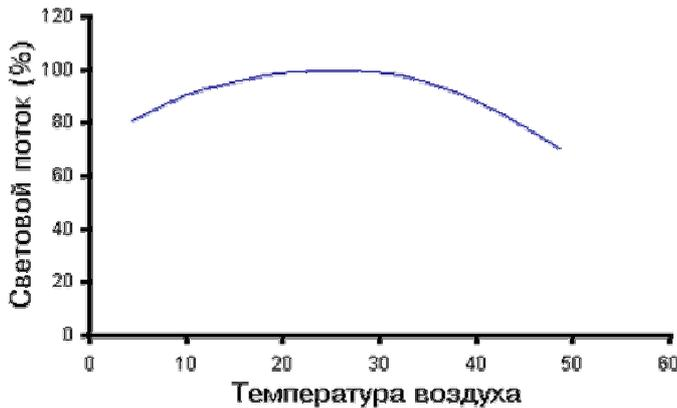
Световой поток, излучаемый лампой очень сильно зависит от температуры окружающего воздуха. Значения потока в люменах, которые указываются в каталогах, измерены при температуре воздуха 25°C. На графике показана типичная кривая для лампы мощностью 40Вт, в воздухе без рефлектора.
