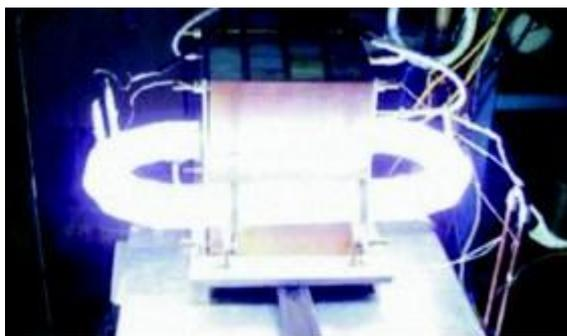
Рис. 2. Мощный (до 100 кВт) индукционный источник света.
