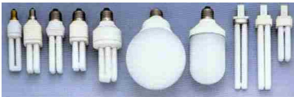
Здесь изображены различные компактные лампы со встроенным балластом. Многие из них имеют цоколь, который вворачивается в обычный патрон для электролампы. К сожалению, такие компактные лампы обычно имеют небольшую мощность, поскольку предназначены для замены электроламп. Правда, недавно появились такие лампы мощностью около 40Вт, для замены 200Вт электролампы.
