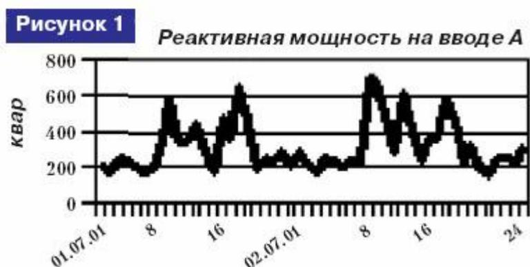
На рис. 1 показан типичный график реактивной мощности в цехе, работающем в одну смену. Характер графика говорит о наличии постоянно действующей реактивной нагрузки около 200 квар и переменных нагрузок, достигающих 500 квар в пиковые периоды. Оптимальным решением для такого случая будет установка нерегулируемого компенсатора мощностью 180...200 квар на высокой стороне и одного или нескольких автоматических регулируемых компенсаторов на низкой стороне.
