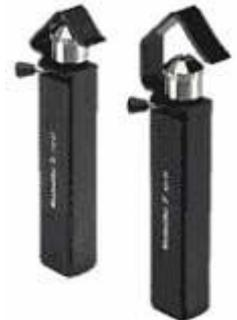
Среди широкого спектра электромонтажного инструмента фирмы *Weidmuller* особую популярность у монтажников получил комплект из двух инструментов для разделки кабеля типа ВВГ или NYM. Для снятия внешней оболочки кабеля используется инструмент AM 25, действующий по принципу кругового ножа; для удаления изоляции с внутренних проводов применяется инструмент для снятия изоляции Stripax, ставший именем- нарицательным у профессиональных электромонтажников.
