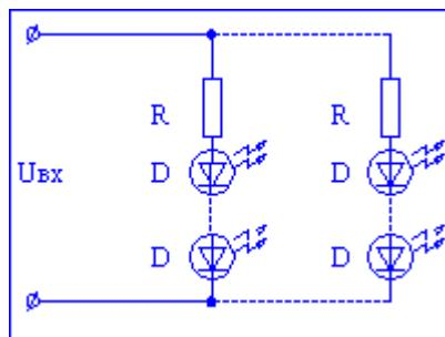
Теперь определимся с подключением нескольких светодиодов. Подключаем 2 красных последовательно. 2 шт \* 2,0 = 4,0 В. Питающее напряжение - 12 В, следовательно лишних - 8,0 В.  $R = 8,0 / 0,02 = 400$  Ом.  $P = 8,0 * 0,2 = 0,16$  Вт.
