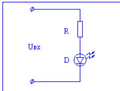
Напряжение на сопротивлении превращается в тепло. Для того, чтобы сопротивление выдержало нагрузку и выделяемое тепло не привело к его выходу из строя, надо вычислить рассеиваемую мощность сопротивления. Как известно (опять возвращаемся к посещаемости уроков физики) мощность:
