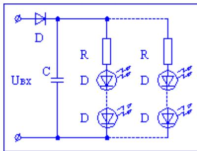
Теперь рассмотрим более сложный вариант. Надо подключить к 12В 30 штук красных по 2,0В. На 12В можем подключить только 6 штук без сопротивлений, соединяя 6 штук последовательно и подключаем - светится. Соединяя еще 6 штук и присоединяя параллельно к первым. При этом через каждые 6 шт будет течь ток в 0,02А. У нас получится 5 цепочек с общим током  $5 * 0,02A = 0,1A$  (уже батареек хватит не на долго).
