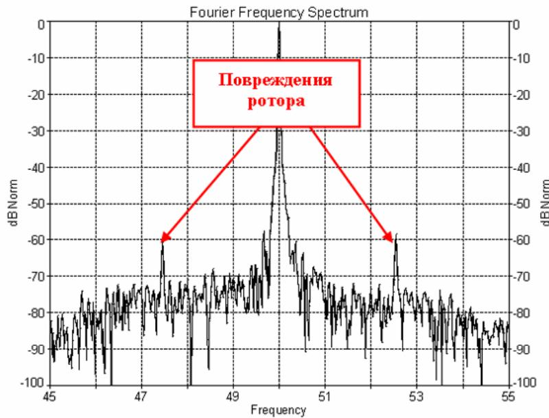
Рис 4. Частоты, характерные для повреждений ротора
