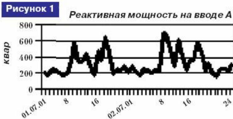
На рис. 1 показан типичный график реактивной мощности в цехе, работающем в одну смену. Характер графика говорит о наличии постоянно действующей реактивной нагрузки около 200 квр и переменных нагрузок, достигающих 500 квр в пиковые периоды. Оптимальным решением для такого случая будет установка нерегулируемого компенсатора мощностью 180...200 квр на высокой стороне и одного или нескольких автоматических регулируемых компенсаторов на низкой стороне.
