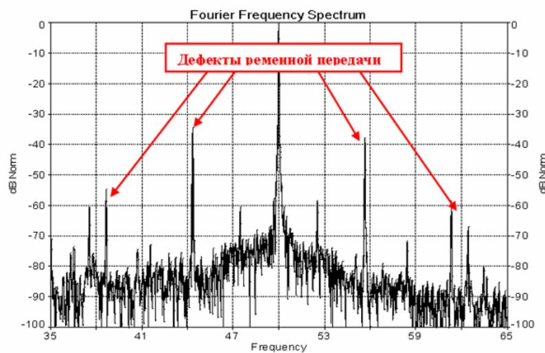
Рис 6. Характерные частоты при наличии дефектов ременной передачи
