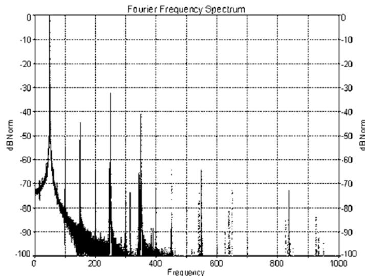
Рис 2. Спектральный состав тока нового электродвигателя
