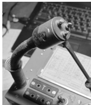
Рис. 4. “УС-П”, вид на разъем шланга питания
