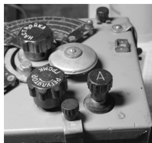
Рис. 2. “УС-П”, вид на антенное гнездо
