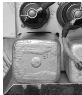
Рис. 7. “УС-П”, анодный автотрансформатор (поздний вариант конструкции)
