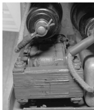
Рис. 6. “УС-П”, анодный автотрансформатор (ранний вариант конструкции)
