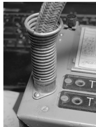
Рис. 5. “УС-П”, вид на шланг питания
