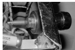
Рис. 3. “УС-П”, вид на антенное гнездо изнутри
