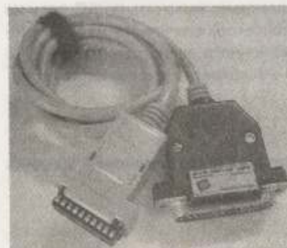
Рис. 2. LPT программатор AVR-ISP
