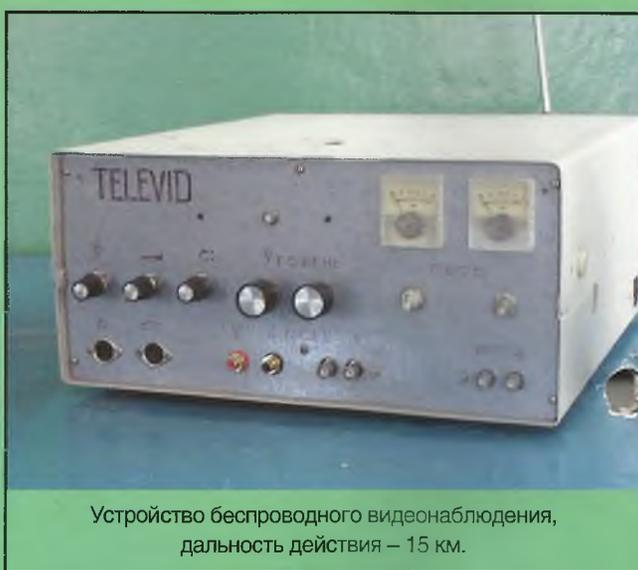
Устройство беспроводного видеонаблюдения, дальность действия – 15 км.
