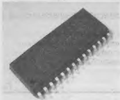
Рис. 11. Универсальный драйвер интерфейсов CH341
