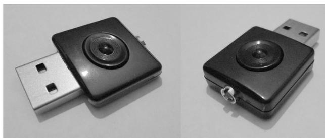
**Рис. 5.** DVB-тюнер на базе чипа RTL-2832
