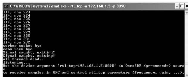
**Рис. 12.** Окно консоли сервера RTL\_TCP. Реакция при подключении клиента
