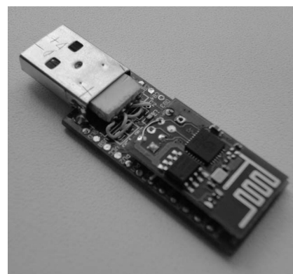
Рис. 4. Монтаж мезонином модуля ESP01 и вилки USB-A на плате модуля UM232
