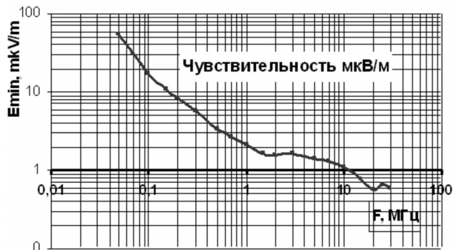
Рис. 12. Зависимость от частоты чувствительности по полю антенны ALA-1350
