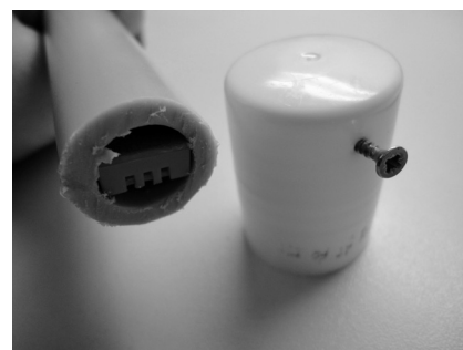
Рис. 3. Размещение датчика влажности и температуры в выносной штанге
