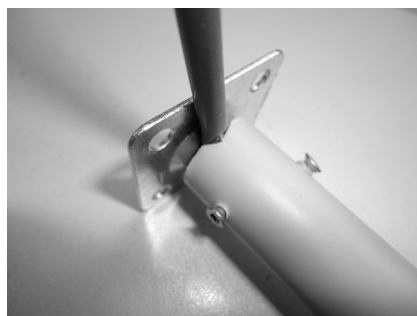
Рис. 4. Фиксация несущей штанги (трубки)
