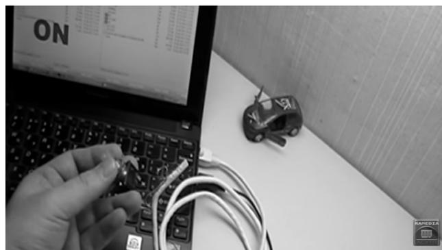
**Рис. 1.** Отслеживаем состояние концевика сетевой картой
