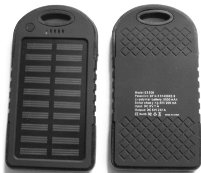
Рис. 1. Внешний вид питающего устройства – упаковка включает в себя солнечную батарею, литий-полимерную аккумуляторную батарею, ответные части соединителей, блок индикации и фонарик
