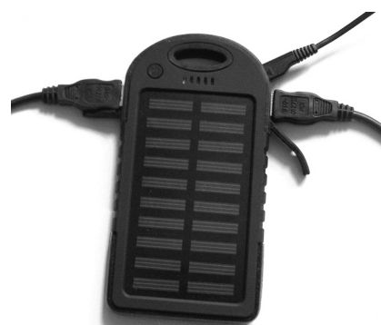
Рис. 3. Внешние соединения с батарейной упаковкой. Справа сверху – с зарядным устройством, с боков подключаются параллельно две нагрузки, ниже виднеются резиновые транспортировочные заглушки. Слева в верхней части видна кнопка включения питания нагрузок и фонарика, светодиод которого расположен над левым фото USB-соединением
