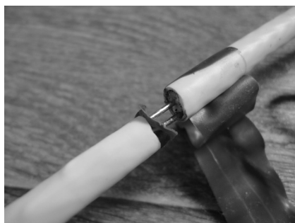
Рис. 12. Монтаж коллинеара к фидеру ничем не отличается от монтажа плечей самого коллинеара
