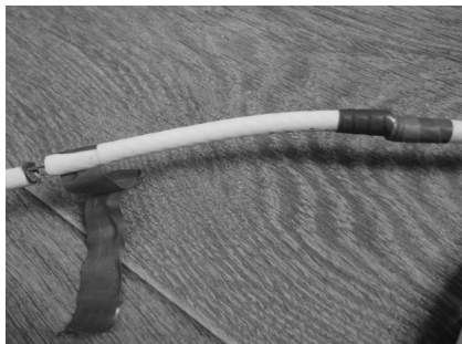
Рис. 12. Монтаж коллинеара к фидеру ничем не отличается от монтажа плечей самого коллинеара
