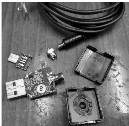
Рис. 2. Замена антенного коннектора донгла DVB-T тюнера
