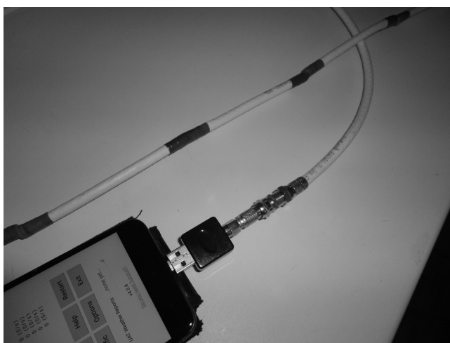
Рис. 1. Окончательный комплект для дальнего приема ADS-B
