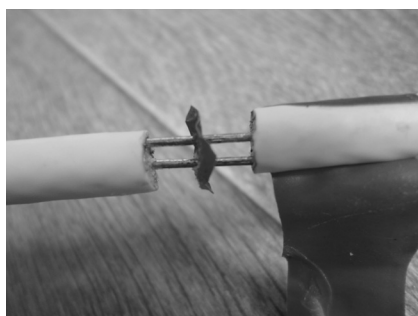
Рис. 11. Монтаж плеч коллинеара друг в друга
