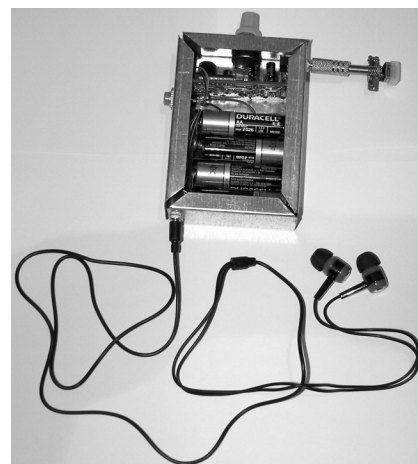
Рис. 10. Фото экспериментального лабораторного УЗЧ в корпусе без крышки. Вверху (по фото) на корпусе установлены: регулятор громкости УЗЧ, слева – кнопка включения питания, справа – на вход УЗЧ подключена смонтированная на штеккере магнитная головка, в качестве сменного датчика, внизу – подключена нагрузка УЗЧ – головные телефоны. Внутри корпуса видна плата УЗЧ, элементы автономной батареи питания
