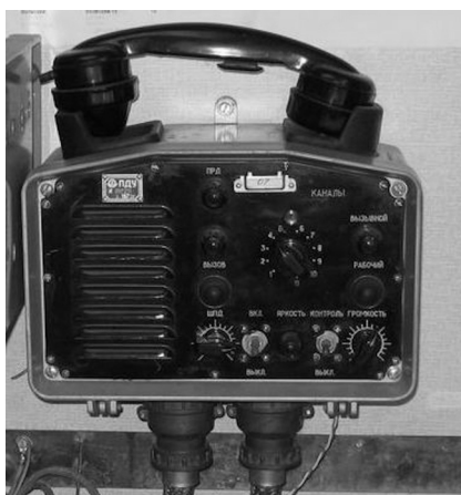
Рис. 1. Фото блока управления радиостанции “Кама-С”. На передней панели видна ручка переключателя каналов с оцифровкой 1...11
