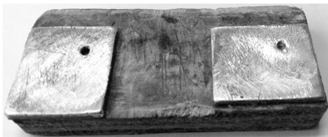
Рис. 1. Подставка для зачистки и резки проводов (уже повидавшая виды)
