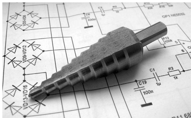
Рис. 5. Ступенчатое сверло для рассверловки отверстий
