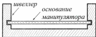
Рис. 1. Крепление основания манипулятора с помощью швеллера. Вид в разрезе с торца манипулятора
