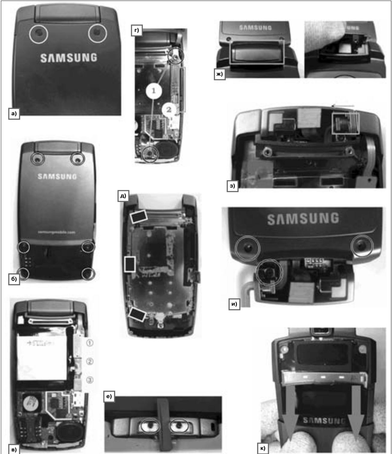
Рис. 1. Разборка телефона
