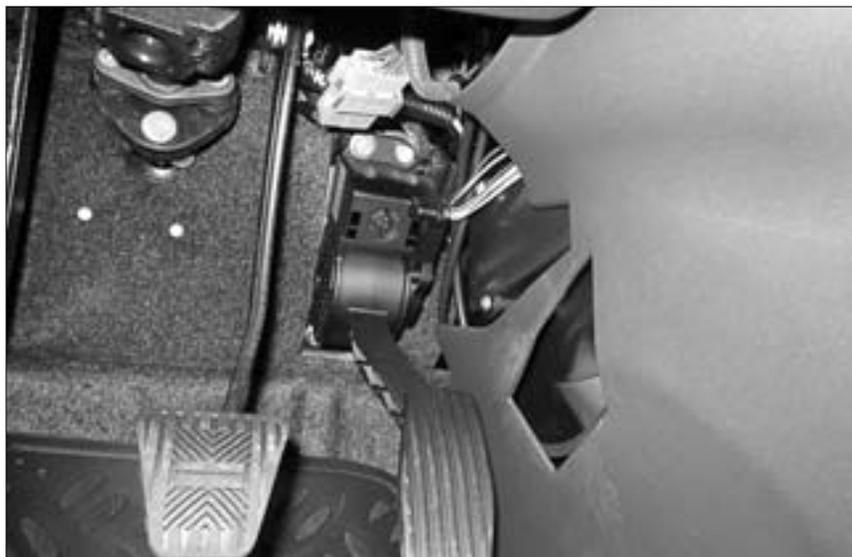
Рис. 2. Внешний вид электронного акселератора на автомобиле Lada Samara
