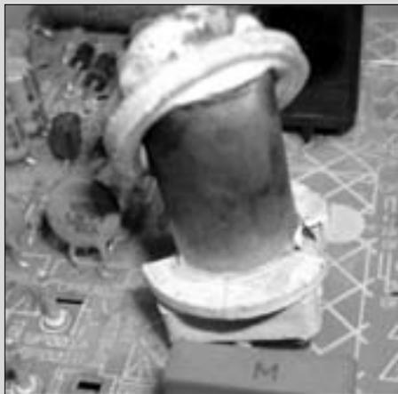
«Работал из последних сил...» — расплавленный ТМС в телевизоре
