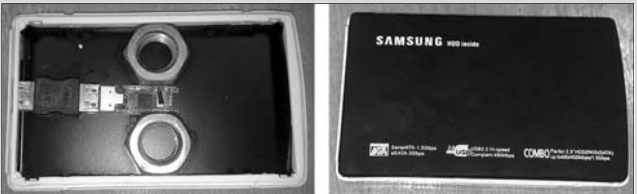
«Пару гаек в корпус — «писк» — получаем «жесткий» диск...». Шедевр китайского инжиниринга — жесткий диск: флэш-память 128 Мб определяется как 500 Гб, запись «по кольцу» сохраняет последние данные
