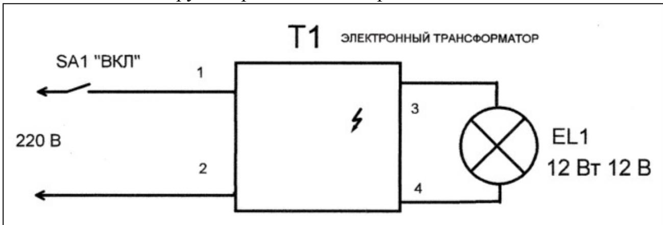
Рис. 3.46. Электрическая схема включения нагрузки к промышленному ЭТ для низковольтных галогенных ламп.
