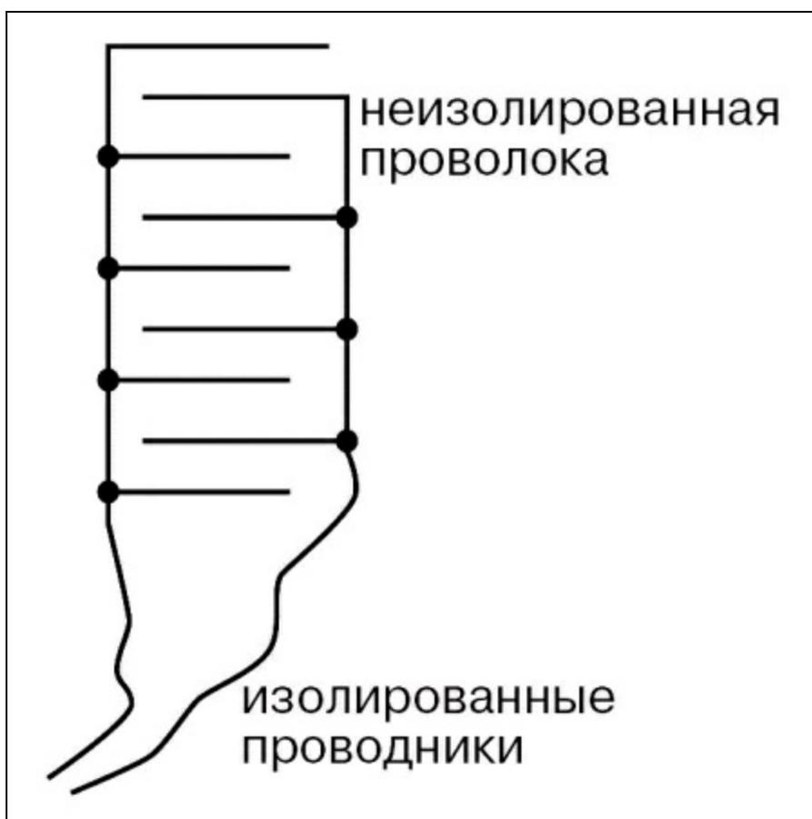
Рис. 2.19. Конструктивная схема подключения электродов к устройству защитного заслона против летающих насекомых
